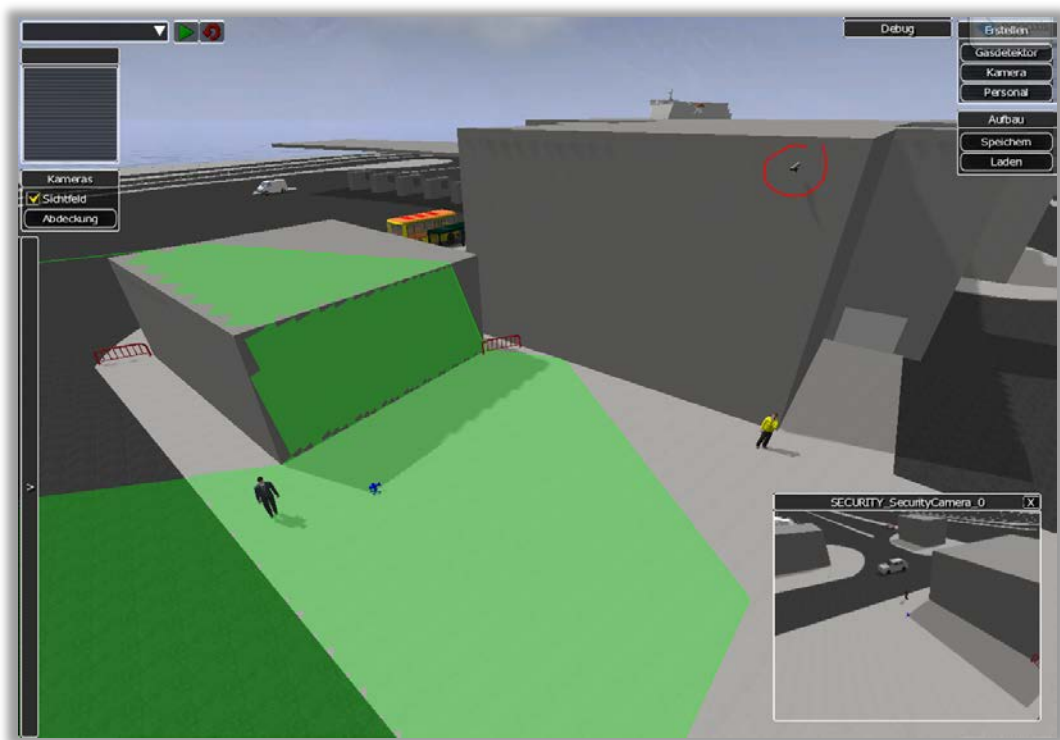
Abb. 8: Überwachungskamera (rechts oben, rot markiert) inkl. Sichtbereich (grün) und Kamerabild im Fenster rechts unten.
